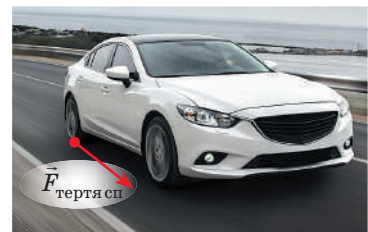
Рис. 13.5. Шини автомобіля в момент дотику з поверхнею дороги намагаються, по суті, здійснити рух назад. У результаті виникає сила тертя спокою, напрямлена вперед, — рушійна сила
