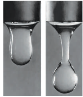
Рис. 33.5. Крапля утримується біля невеликого отвору доти, доки сила поверхнього натягу зрівноважує силу тяжіння
