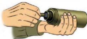
Іл. 4.9. Угвинчування запалу в трубку кришки корпусу протитанкової гранати
