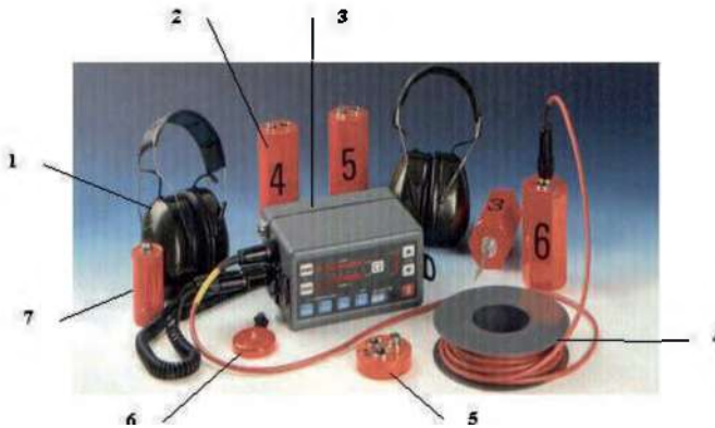
Іл. 34.5. Загальний вигляд геофона: 1 — навушники; 2 — датчики; 3 — пульт; 4 — котушка з кабелем; 5 — розгалуження; 6 — приймач речового сигналу; 7 — магніт
