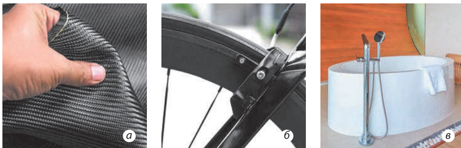
Мал. 38.2. Використання композитних матеріалів: вуглецеву тканину (вуглеволокно) (а) використовують для армування деталей спортивних велосипедів та автомобілів (б), склопластиком (склотканиною) армують акрилові ванни (в) тощо
