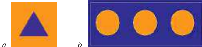
Лл. 41.7 Міжнародні розпізнавальні знаки цивільного захисту: а) рівносторонній блакитний трикутник на оранжевому тлі; б) спеціальний знак для обладнання та споруд — три круги помаранчевого кольору з відстанями між ними, що дорівнюють радіусу круга
