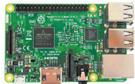
Мал. 19. Одна з реалізацій Raspberry Pi
