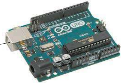
Мал. 10. Основна плата (апаратна частина) Arduino (під'єднується до USB порту ПК або використовується самостійно)
