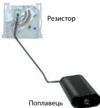
Мал. 4. Датчик рівня пального в автомобілі
