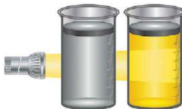
Мал. 3.7. Ефект Тіндалля: у разі пропускання світла крізь істинний розчин промінь не розсіюється, на відміну від проходження крізь колоїдний розчин
