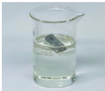
Мал. 31.6. У літію найменша серед усіх металів густина ( 0,53 \text{ г/см}^3 ), він плаває не лише на поверхні води (як інші лужні метали), а й на поверхні гасу ( 0,81 \text{ г/см}^3 )
