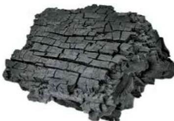
Мал. 28.6. Деревне вугілля зберігає структуру деревини
