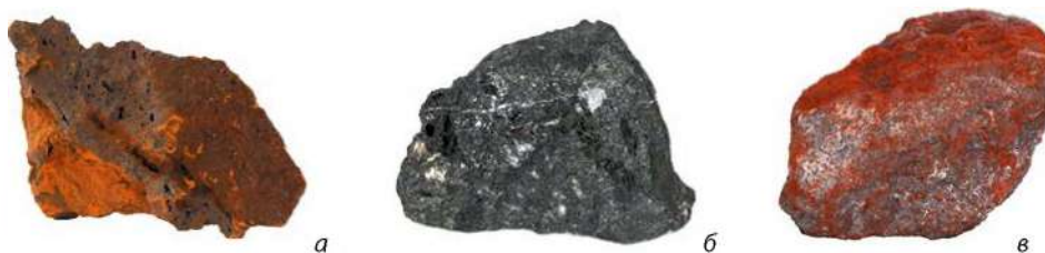
Мал. 36.2. Поширені залізні руди: a — бурий залізняк (лимоніт) \text{Fe}_2\text{O}_3\cdot x\text{H}_2\text{O} ; б — магнітний залізняк (магнетит) \text{Fe}_3\text{O}_4 ; в — червоний залізняк (гематит) \text{Fe}_2\text{O}_3
