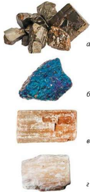
Мал. 20.6. Природні сульфуровмісні мінерали: а — пірит \text{FeS}_2 ; б — халькопірит \text{CuFeS}_2 ; в — гіпс; г — алебастр
