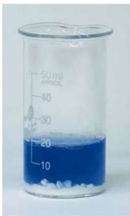
Мал. 34.2. У результаті взаємодії кальцію з водою частина кальцій гідроксиду розчиняється у воді і змінює забарвлення універсального індикатора, а надлишок кальцій гідроксиду утворює білий осад
