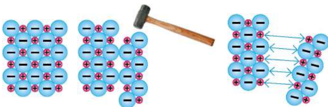
Мал. 10.3. У іонних речовинах зміщення шарів призводить до відштовхування однойменно заряджених іонів та руйнування кристала
