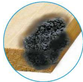
Мал. 22.2. Обвуглювання деревини концентрованою сульфатною кислотою
