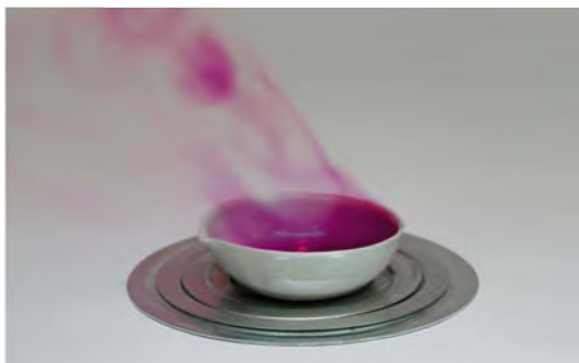
Мал. 35.3. Під час взаємодії алюмінію з йодом виділяється велика кількість теплоти, під дією якої йод частково сублимує, утворюючи хмару випарів йоду фіолетового кольору
