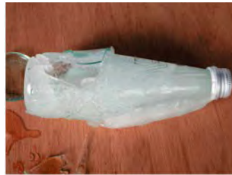
Мал. 7.5. У рідкій воді молекули води розташовані неупорядковано та близько одна до одної; у льоду молекули розташовані впорядковано й на більшій відстані, тому лід легший за воду (а). Під час замерзання вода розширюється, внаслідок чого закрита скляна пляшка з водою в морозилці тріскається (б)
