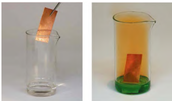
Мал. 25.1. Взаємодія міді з концентрованою нітратною кислотою
