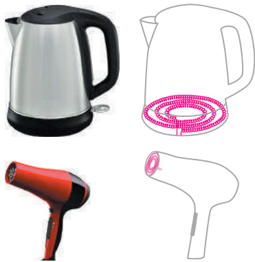
Рис. 3.3. Основна частина будь-якого нагрівального пристрою — нагрівальний елемент, який являє собою виготовлений із тугоплавкого матеріалу з великим питомим опором провідник, що має невелику (порівняно з підвідними проводами) площу поперечного перерізу
