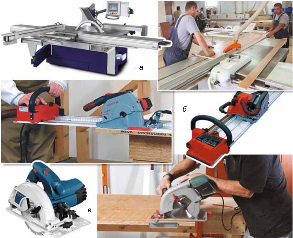
Мал. 45. Різання плит: а – на форматно-розкрійних верстатах; б – мобільною системою; в – дисковою пилкою
