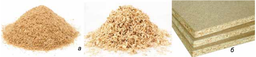
Мал. 20. Деревостружкова плита: а – матеріал для ДСП (тирса, стружка); б – плита
