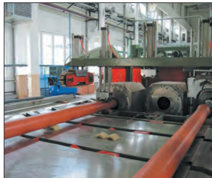
Мал. 5. Калуський трубний завод. Із 2009 р. в Калуші працює підприємство, яке виробляє пластикові труби для водо- та газопостачання, каналізації. Такі труби не піддаються корозії, не потребують фарбування, добре гнуться, мають спрощений процес з'єднання. Основними чинниками вибору місця розташування заводу стали близькість до постачальника сировини (підприємство «Карпатнафтохім») та наявність споживача.
