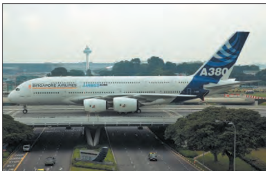
Мал. 3. Двопалубний реактивний пасажирський авіалайнер Аеробус А380 — найбільший серійний літак у світі (висота — 24,08 м, довжина — 72,75 м, розмах крила — 79,75 м). Він перевозить 525 пасажирів у салонах трьох класів або 853 — в однокласовому варіанті. Може здійснювати безпосадочні перельоти на відстань понад 15 тис. км.
