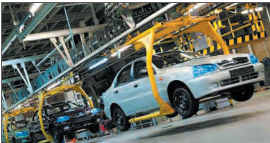
Мал. 1. Конвеєр Запорізького автомобільного заводу. Масове виробництво машинобудівної продукції має значні переваги над одиничним. Воно передбачає тісні зв'язки з підприємствами, що постачають окремі деталі та вузли.
