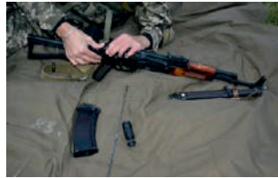
Іл. 19.6. Відокремлення кришки ствольної коробки
