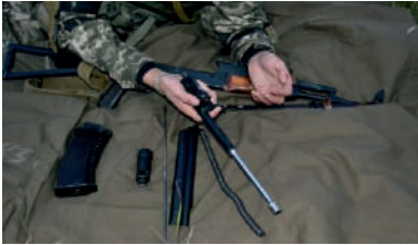
Іл. 19.9. Відокремлення затвора від затворної рами
