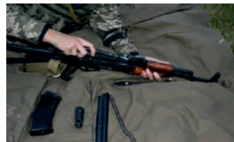
Іл. 19.8. Відокремлення затворної рами із затвором
